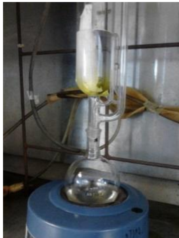
Figura13. Extracción de grasa en Soxhlet.
