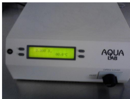
Figura 12. Medición de actividad de agua ( a_w ).
