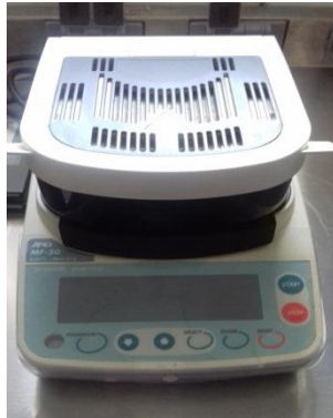
Figura11. Termobalanza medición de % de Humedad.
