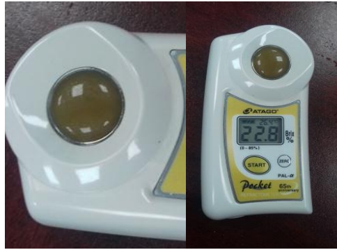
Figura10. Muestras de Tejuino, medición de °Brix.
